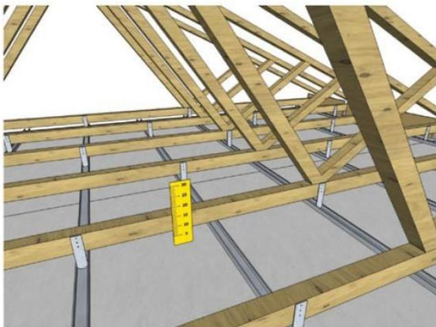
Figure 7 – Repérage de la hauteur d'isolant à souffler
